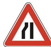
Zúžená vozovka sprava
